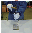
HDD機能破壊
