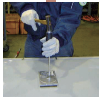
HDD機能破壊
